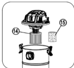
Сборка спонжевого фильтра для влажной уборки / фильтра HEPA для сухой уборки и функции автоматической очистки
