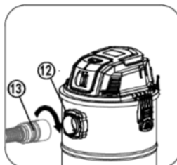
Сборка шланга для работы
